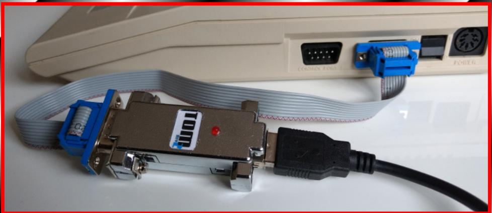
**Durch die mitgelieferte Verlängerung in Form eines Flachbandkabels, entfällt das lästige Entfernen des Gehäuses.**
